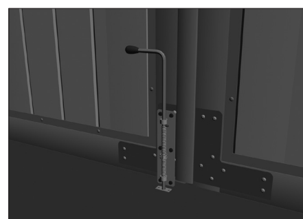
Закрепите задвижку с помощью 6 саморезов.
