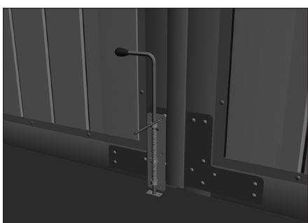
Разметьте отверстия для установки задвижки на одной из створок.
